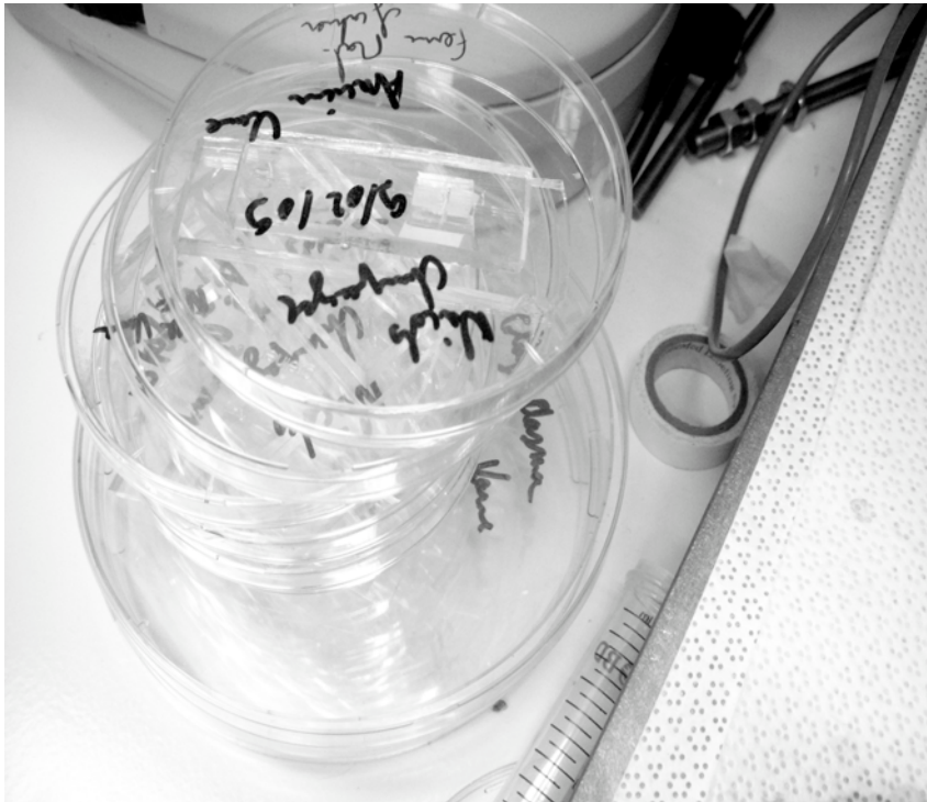
Boîtes de Petri contenant des circuits microfluidiques en silicone transparent destinés à étudier le transport dans des milieux poreux modèles (travaux de thèse de Nicolas Champagne)
